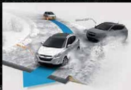
**Control electrónico de estabilidad (ESC)**
